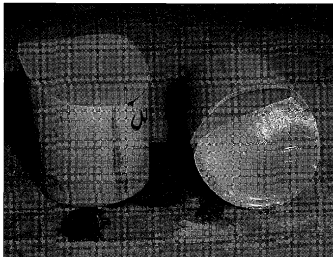
写真1 ナトリウムにより破壊したペースト
