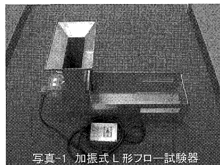
図-1 加振式 L 形フロー試験器
