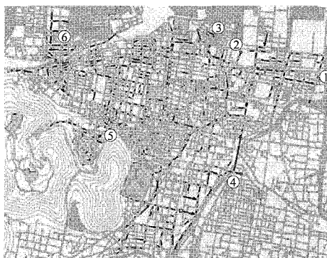
図-2 モデル化した下水道管路網
