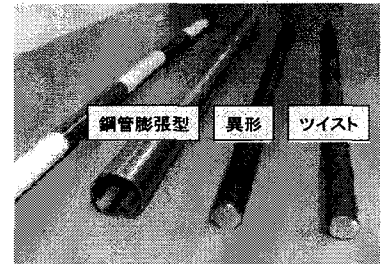
写真-1 実験に使用した3種類のロックボルト
