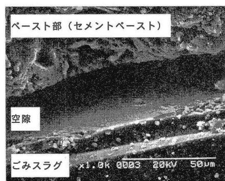
写真-1 骨材界面観察（スラグ置換率 100%、凍結融解試験後）
