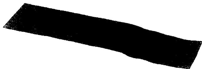
図3 画像計測による再現腐食面
