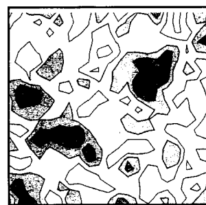
図 6. 60 年経過時の腐食深等高線図
