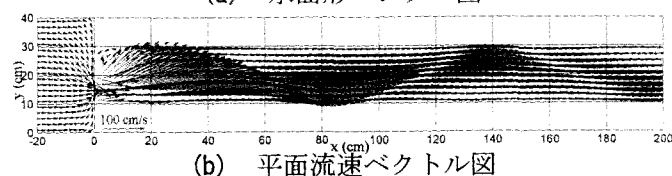
図-3 矩形断面水路における計算結果
