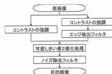
図1 導出した画像処理フロー
