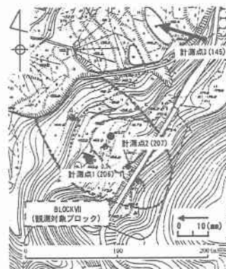
図-5 両計測点の水平面内変位図 (2000.11.1～2002.4.2)
