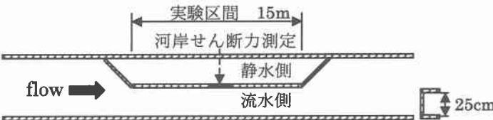
図-1 実験水路平面図・断面図
