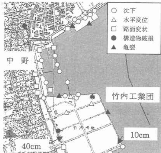
図-4 液状化被害箇所および地盤の沈下量
