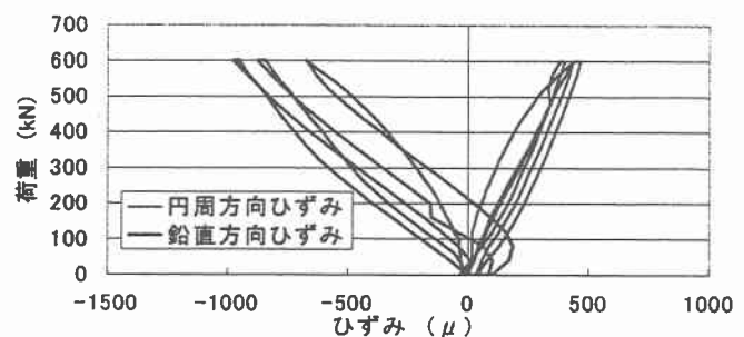
図-4(b) 弾性領域での荷重とひずみの関係 ストレインゲージ
