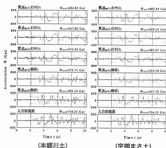
図6 地震波の入力加速度と応答加速度の時刻歴
