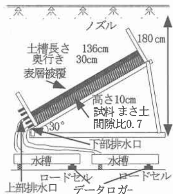
図-1 模型斜面土槽実験装置概略図
