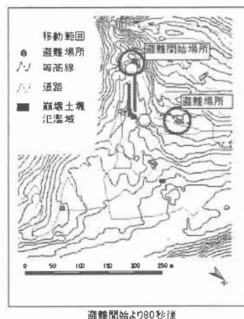
図-5 時間毎の人の移動範囲と崩壊土塊の氾濫域
