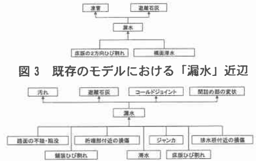
図3 既存のモデルにおける「漏水」近辺
