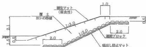
図-2 低水護岸断面図
