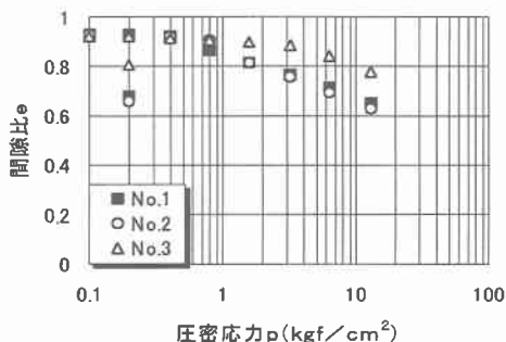
図-4 間隙比と圧密応力の関係
