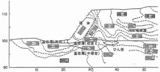
図-3 二次元比抵抗断面図
