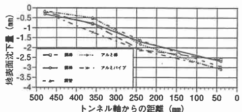
図-8 横断方向の地表面の変位状況(切羽は測点の真上)
