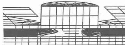
図-6 3次元解析の過剰間隙水圧比分布
