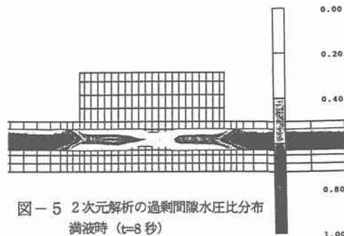
図-5 2次元解析の過剰間隙水圧比分布
