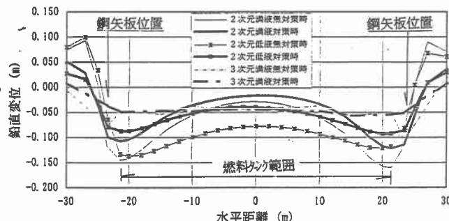
図-8 20秒後の残存沈下分布
