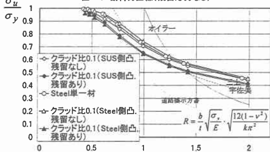
図－6 耐荷力曲線(残留応力あり)
