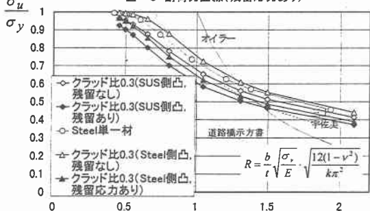
図－7 耐荷力曲線(残留応力あり)
