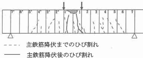
図-3 NORMALのひび割れ状況
