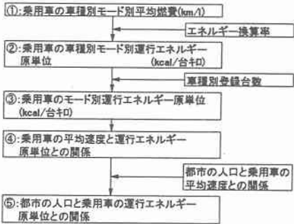
図-1 乗用車の運行エネルギー原単位推計手順
