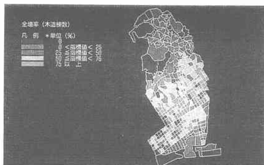
写真2 地区被害表示結果(全壊率)
