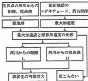
図1 液状化発生簡易判定法のフロー
