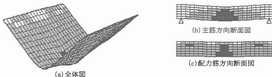
図3 解析により得られた曲げ破壊モードの変形および応力分布の例
