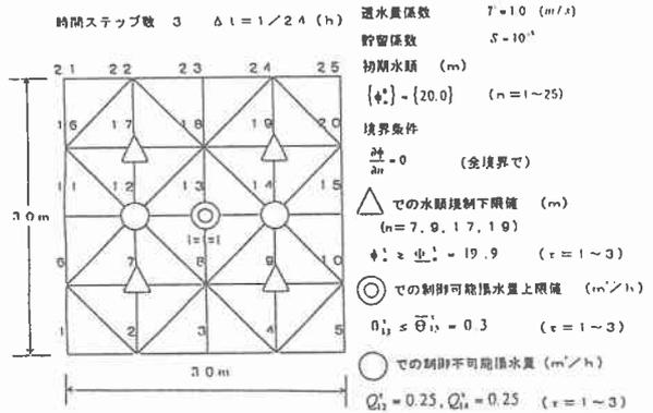
4. 有限要素・動的線形計画法による地下水モデルの最適制御
