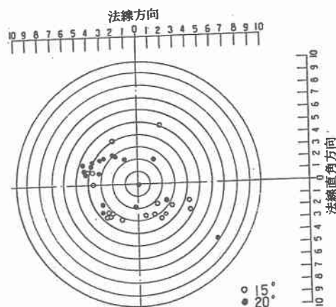
図-5 杭頭の設計位置よりのずれ
