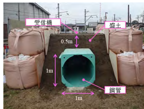
図-9 製作した盛土写真
