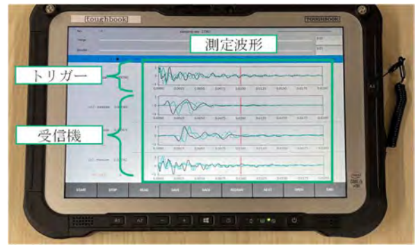
図-5 測定した弾性波の表示例
