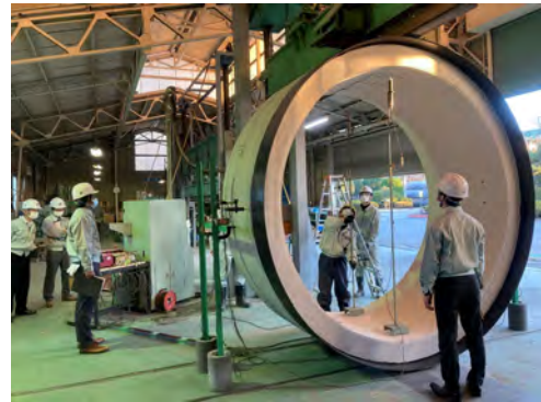
写真-1 外圧強さ試験状況
