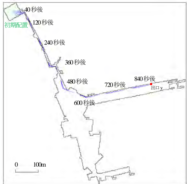
図-13 名古屋駅前地下街の避難する人の分布の解析結果 (時間毎の人の分布を合わせて表示している)
