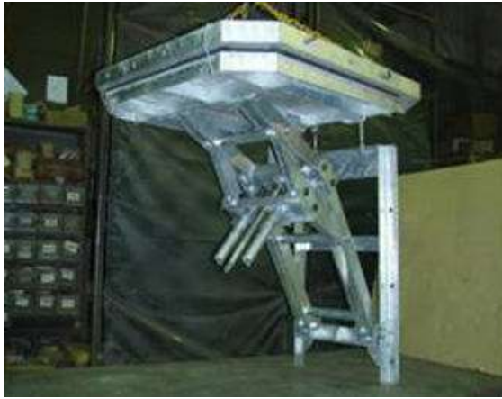
写真-2 換気口浸水防止機
