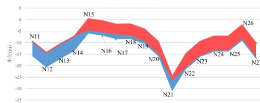
図-9 長堀鶴見緑地線の浸水断面図
