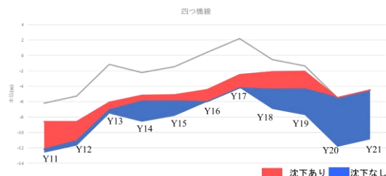
図-8 四つ橋線の浸水断面図(以下凡例は同じ)
