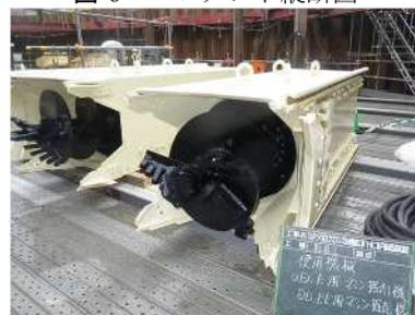
図-7 オーガータイプ掘削装置
