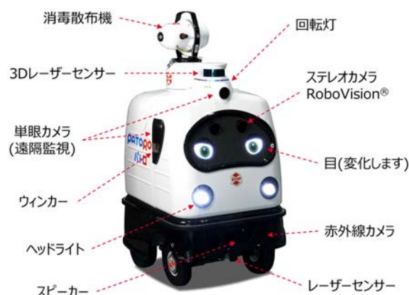
図-2 無人警備消毒ロボ「パトロ」の構成
