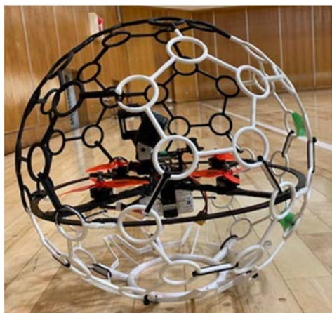
写真-3 トンネル検査に導入したドローン
