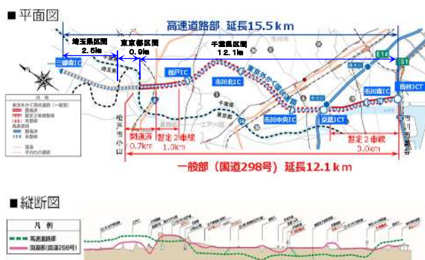
図-2 外環道 三郷南 IC～高谷 JCT 間の平面・縦断面図
