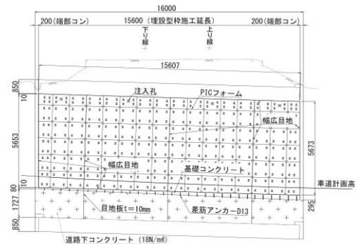
図-30 内装工側壁変更図
