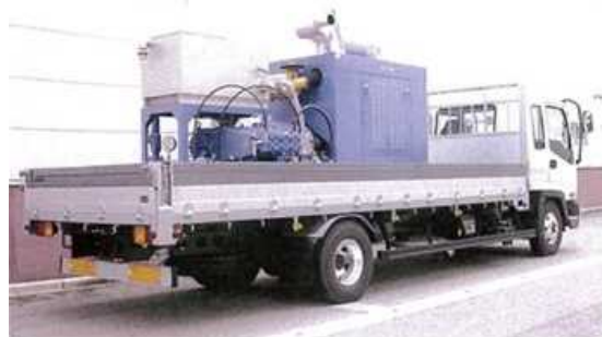
写真-2 超高压水発生機の外観
