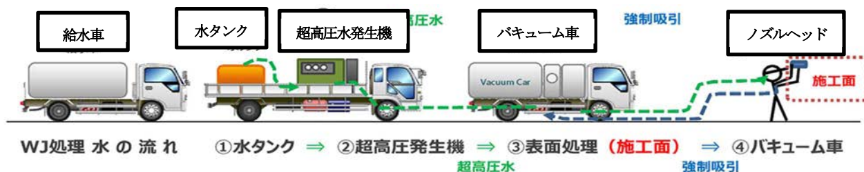
図-1 洗浄システムの概要図
