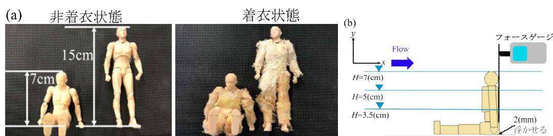
図-1 (a) 人体模型 (1/10 スケール) の姿勢変化, (b) 抗力計測
