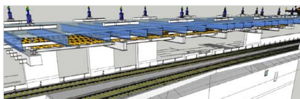
工事桁扛上後軌道敷設
