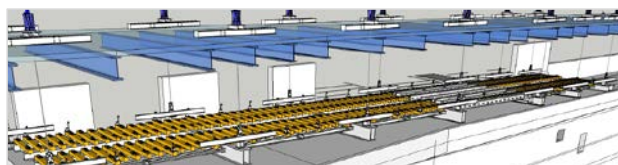
工事桁扛上前
