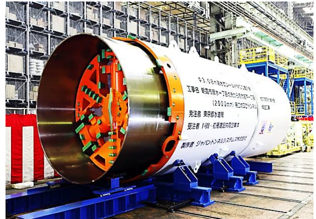
写真-5 第5工区シールドマシン (貫入リング押出時)
