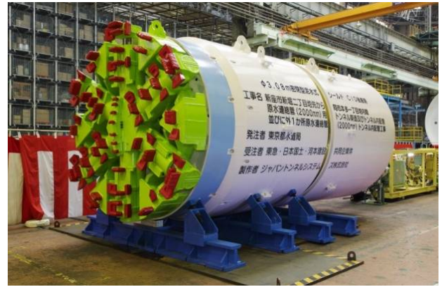
写真-4 第3工区シールドマシン
