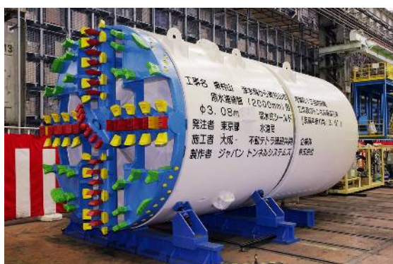
写真-1 第1工区シールドマシン
