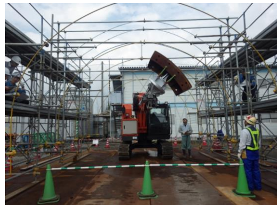
写真-4 ハンドリング機実証実験
