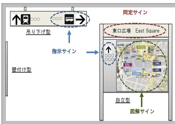
図-4 種類、設置形式による案内サインのイメージ
