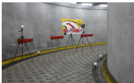
図-6 レーザ計測機と真球の配置
