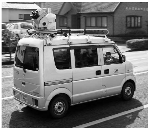
図-1 軽ワゴン後方に設置した MMS 機器
