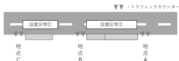
図-11 トラフィックカウンターによる点灯制御
