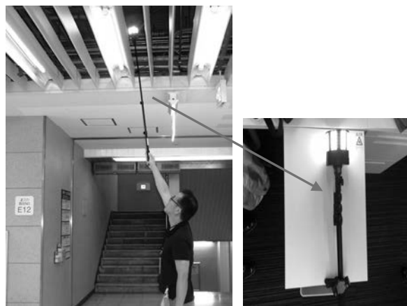
写真-2 全方位カメラ撮影状況、LED点灯状況
